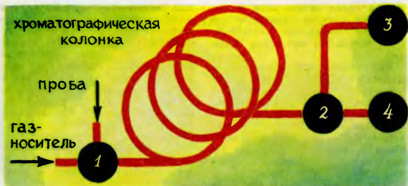
Схема современного хроматографа. Цифрами 1, 2, 3, 4 обозначены распределительные краны.
